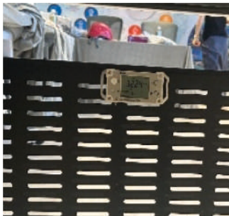
(d) Indoor air temperature measurement
